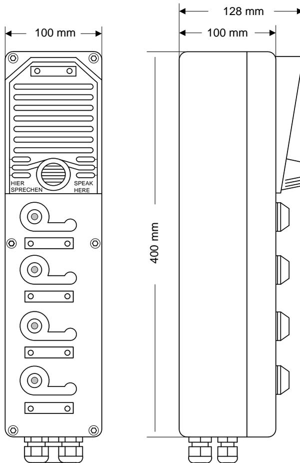
Die explosionsgeschützte Sprechstelle hat vier Befestigungslöcher für eine direkte Wandmontage.
